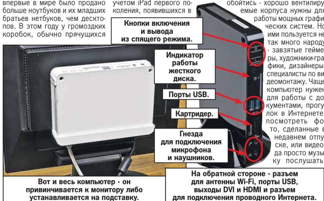
Вот и весь компьютер - он привинчивается к монитору либо устанавливается на подставку.
