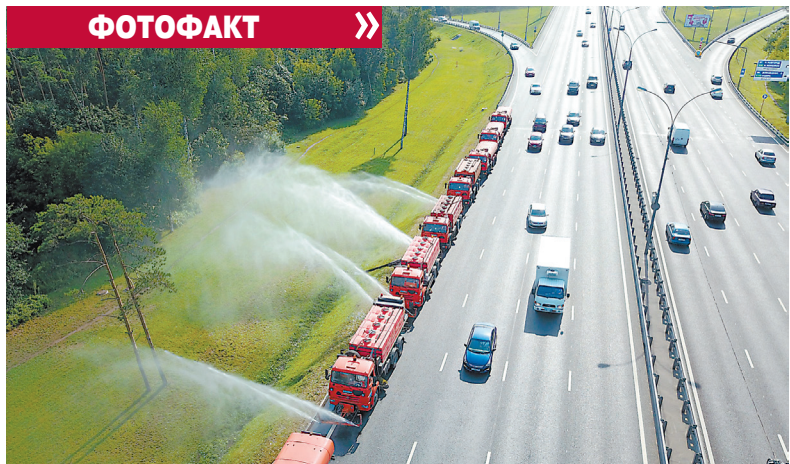
Как только столбик термометра поднимается до 25 градусов и ползёт выше, столицу начинают охлаждать. На улицы выходят те же машины, что моют улицы. Только струи воды направлены вверх. Так охлаждаются воздух и дорожное полотно, которое при сильной жаре подвержено деформации.
